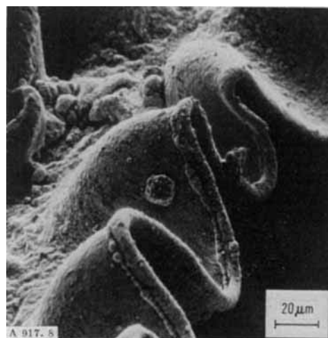
Abb. 8. Teilabschnitt eines sinusförmig gefalteten Zellstege. Aufwulstung der Randzonen. Fixierte Polyoxymethylen-Menge: 88 Gew.-%. Stereoscan-Aufnahme kurz vor Beginn einsetzender Zellfüllung.
